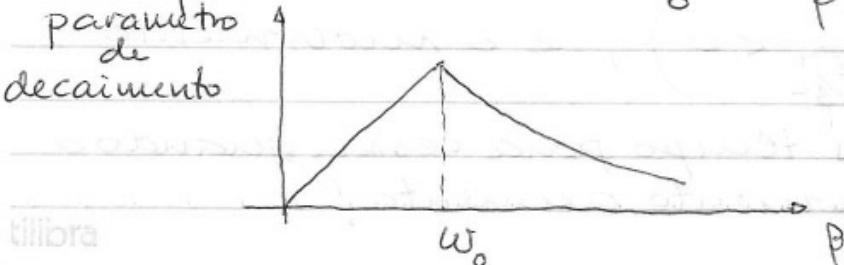
O gráfico mostra que o movimento se extingue + rápido quando  $\beta = \omega_0$  (situação crítica). Há situações onde isto é desejável (agulha de aparelho de medida analógico, por exemplo, ou ~~sistema~~ sistema de amortecimento de carros). Nestes casos, devemos escolher amortecimento próximo ao crítico.
